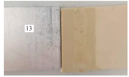
图3 直接脱开的连接接头(试样编号 13) Fig.3 Specimen with low adhesion (sample 13)
